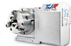
▲ 安装手动三爪夹头实例
