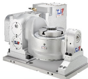
FAD-170F-RC210 (单DD) 倾斜轴: 滚子凸轮 传动( 50 rpm ) 旋转轴: DD马达 传动( 300 rpm )
